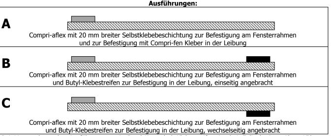
Bei Verwendung der Ausführungen mit Butyl-Kautschuk-Klebestreifen ist bei Folienbreiten über 150 mm eine zusätzliche mechanische Befestigung oder zusätzliches Ankleben mit Compri-fen Kleber notwendig (Fassadenbereich).
